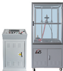
膨胀量试验台
